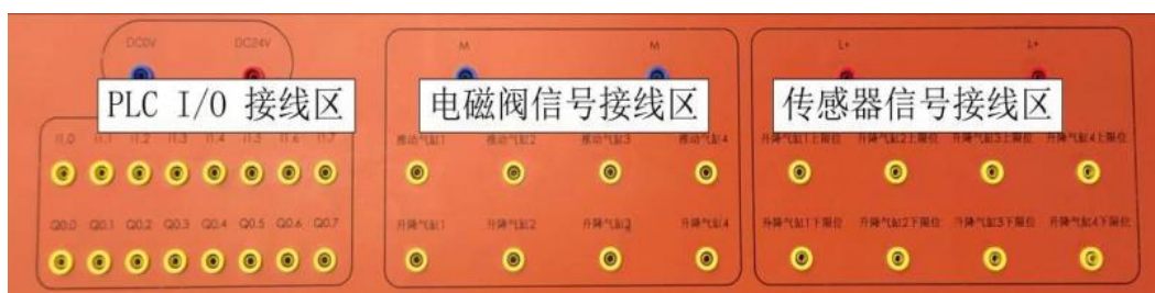
图 A-17 PLC 的 IO 信号接线区域
