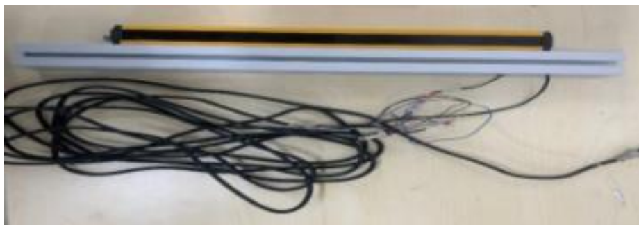
图 A-8 光栅装配器件和电气接线
