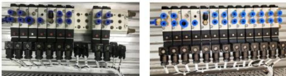
图A-9 电磁阀安装前和安装后示意图
