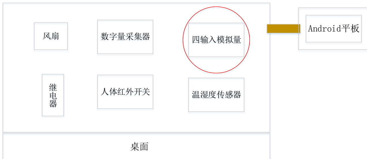
设备工位安装布局图
